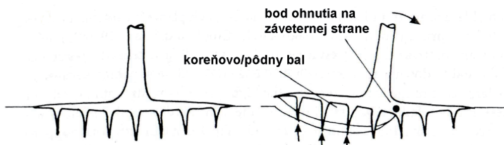
Obrázok 2. Pri široko rozprestierajúcom sa koreňovom systéme s kolovými koreňmi sa koreňový systém vypáči okolo bodu ohnutia. Odolnosť voči vyvráteniu je ovplyvnená tromi komponentmi: tuhosťou v bode ohnutia, odolnosťou kolových koreňov voči vytiahnutiu na náveternej strane a hmotnosť koreňovo/pôdneho balu (SMIT et al. 2000)
